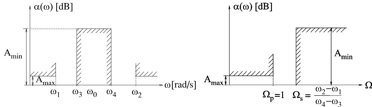
Pošto se za dobijeni gabarit prototipskog NF filtra odredi odgovarajuća prenosna funkcija  $H(S)$ , prenosna funkcija filtra nepropusnika opsega frekvencija se dobija smenom:
