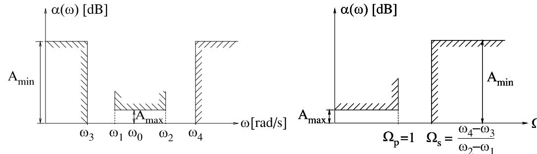
Pošto se za dobijeni gabarit prototipskog NF filtra odredi odgovarajuća prenosna funkcija  $H(S)$ , prenosna funkcija filtra propusnika opsega frekvencija se dobija sменом:
