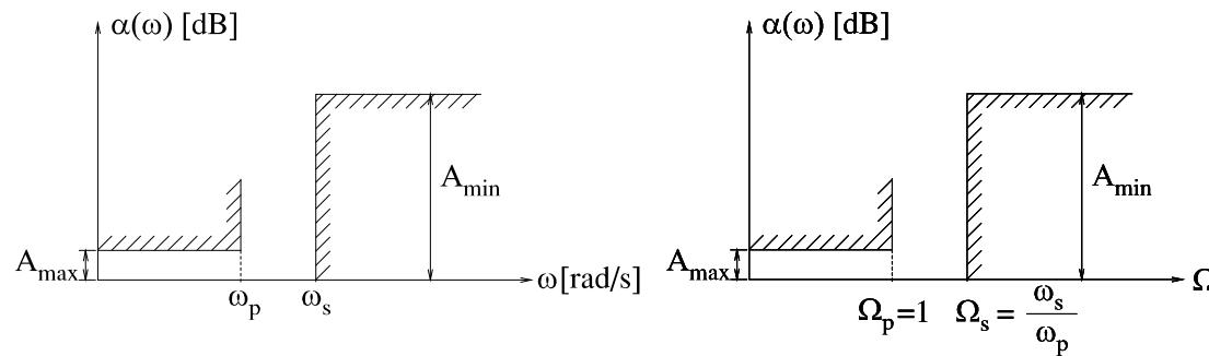
Pošto se za dobijeni gabarit prototipskog NF filtra odredi odgovarajuća prenosna funkcija  $H(S)$ , prenosna funkcija filtra propusnika niskih frekvencija se dobija smenom:
