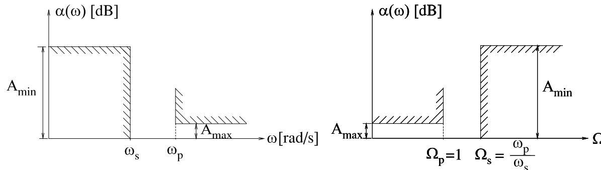
Pošto se za dobijeni gabarit prototipskog NF filtra odredi odgovarajuća prenosna funkcija  $H(S)$ , prenosna funkcija filtra propusnika visokih frekvencija se dobija smenom:
